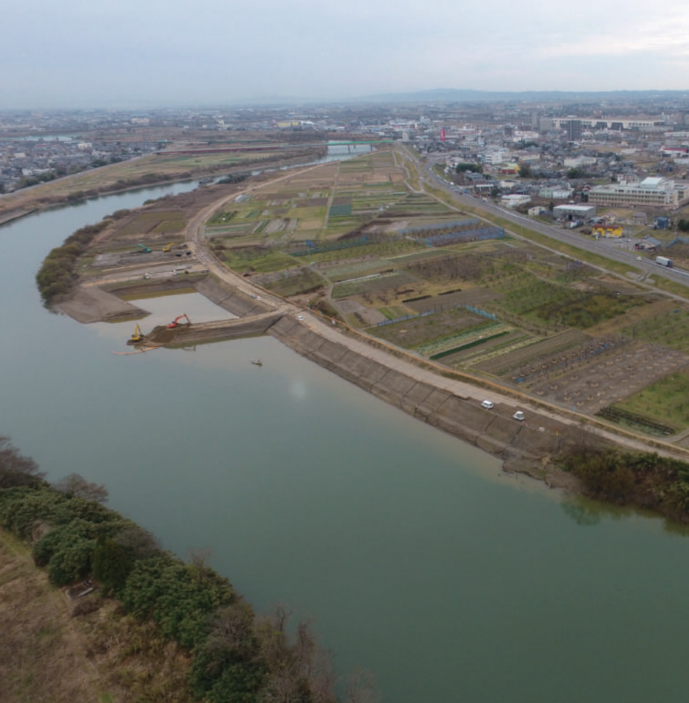
竣工後の信濃川。河川幅が広がり、流れる水の水位が低下した
