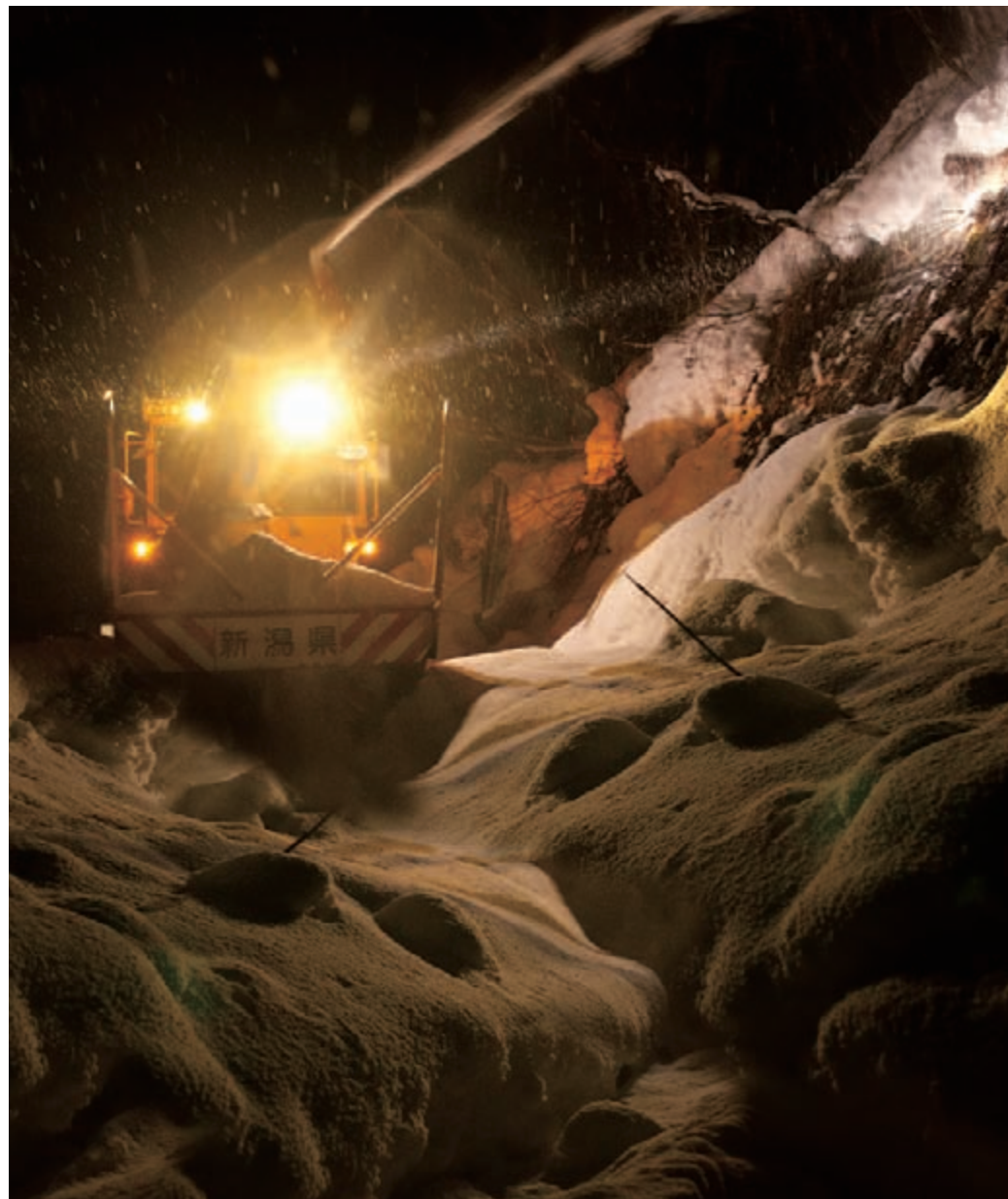
雪を巻き込んで進む除雪ロータリー。雪の下に構造物にも細心の注意を払う。
